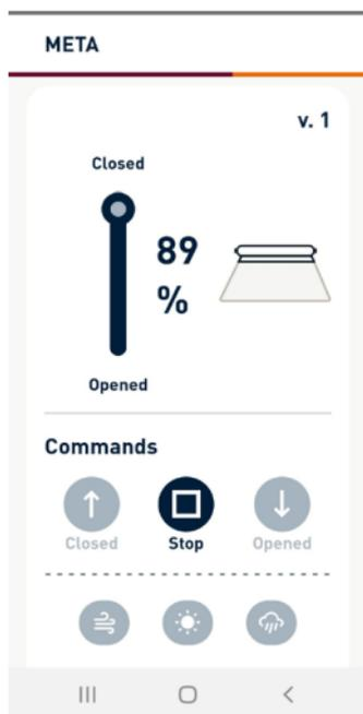
Grâce aux boutons HAUT/BAS/STOP du panneau de contrôle, il est possible de fermer/ouvrir/arrêter le store.
