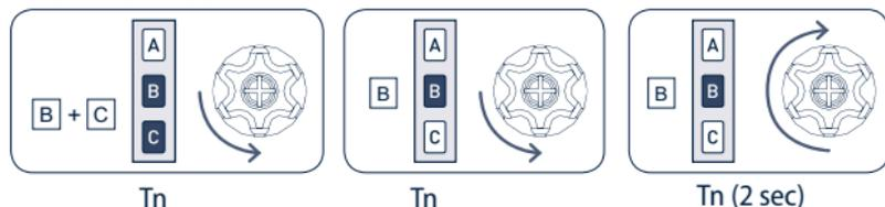
À partir de ce moment, le moteur bouge dans le mode "HOMME PRÉSENT". Cela permet d'exécuter avec précision la mise au point de la position intermédiaire supplémentaire. Accomplir les opérations suivantes:
