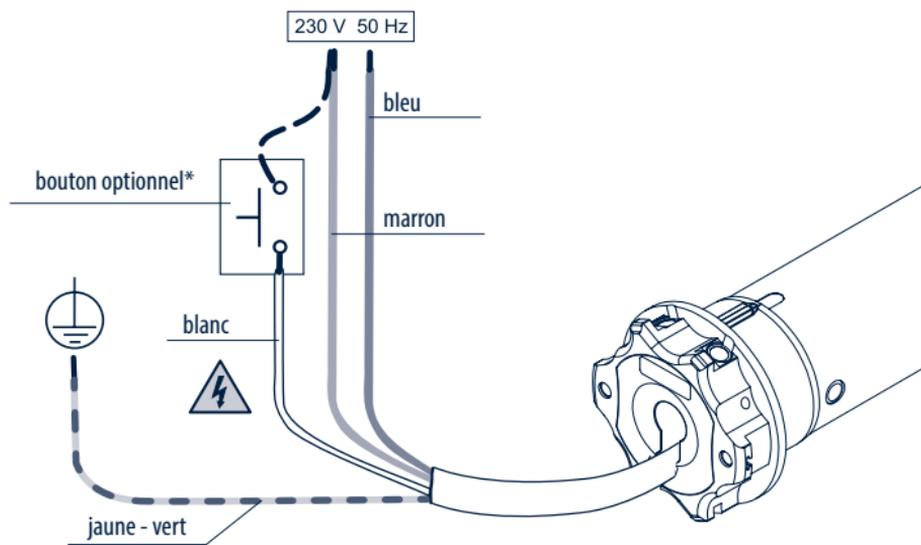
\*L'installation du bouton est facultative; la connexion peut être faite avec la phase (fil marron) ou avec le neutre (fil bleu) indifféremment. Le bouton permet d'actionner le moteur en mode séquentiel (montée, stop, descente, stop, ...).
