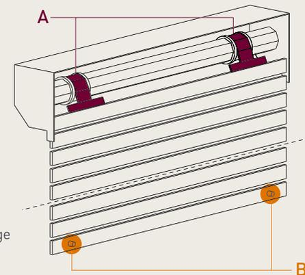
Les dispositifs mécaniques de blocage **A+B** sont obligatoires pour un bon fonctionnement.
