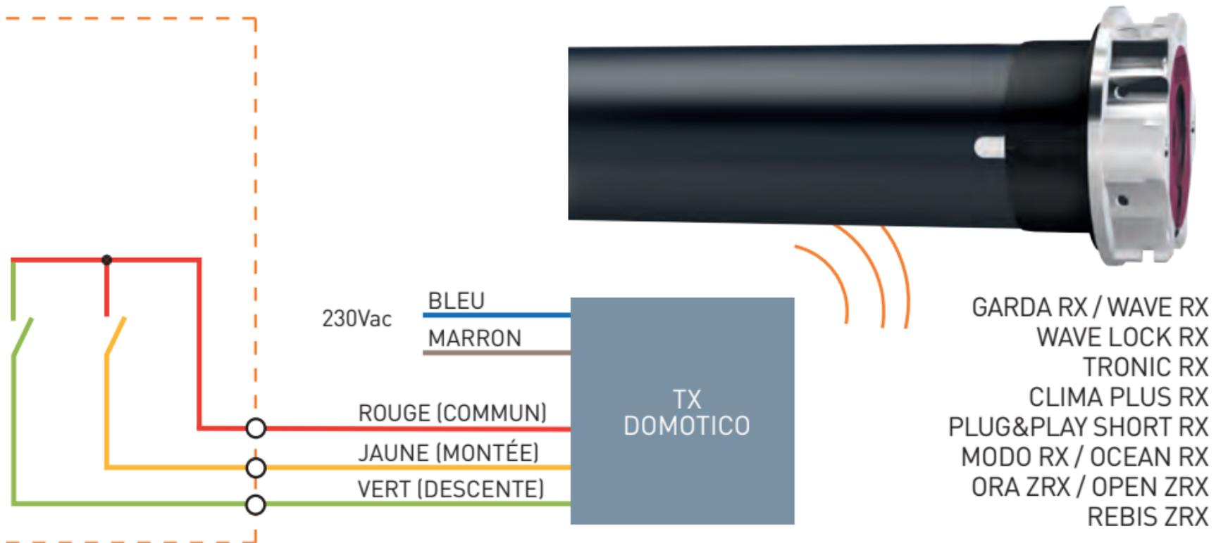
L'ÉMETTEUR DOMOTIQUE EST PRÉ-PROGRAMMÉ À L'USINE POUR FONCTIONNER EN MODE MANUEL.
