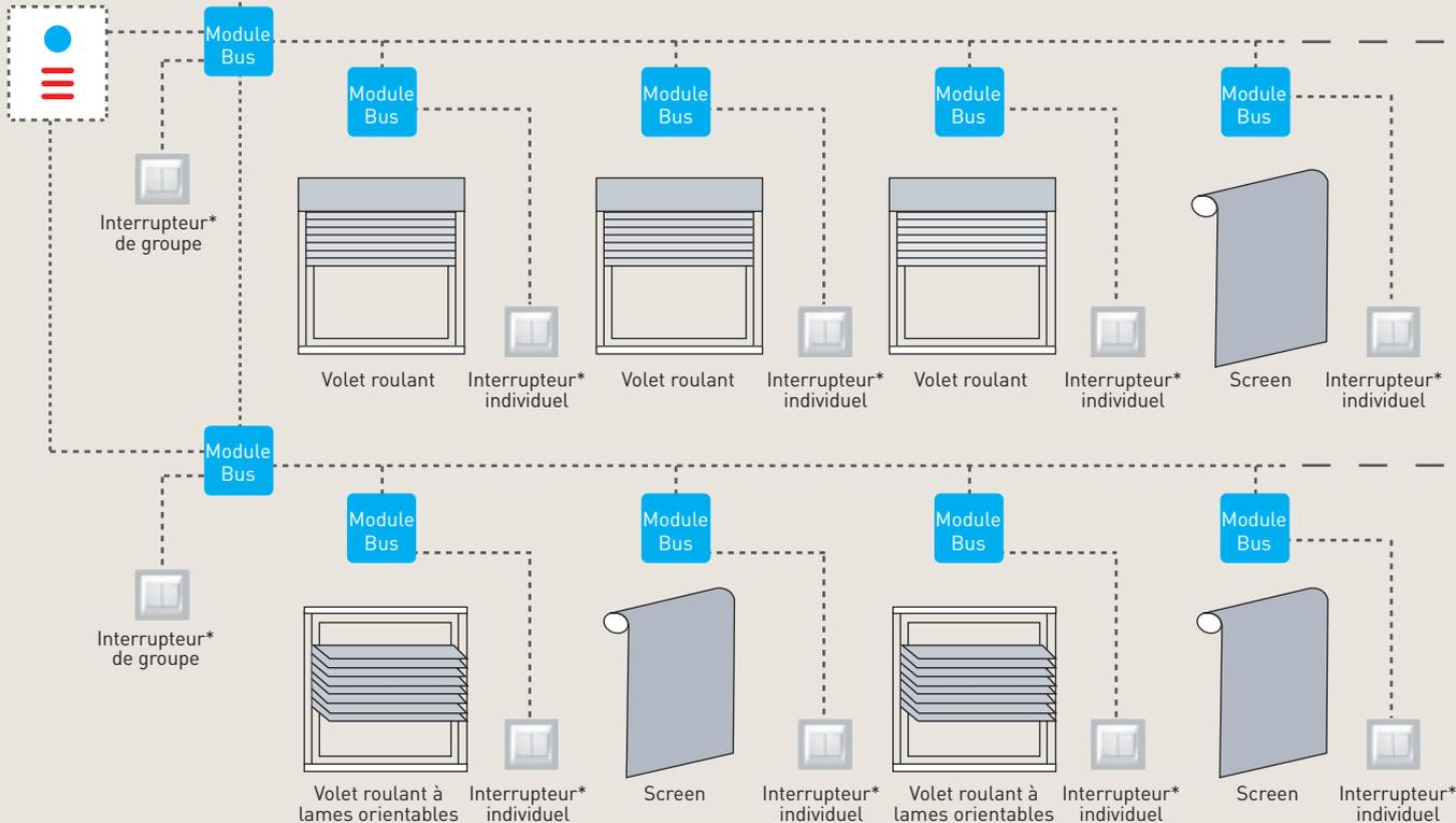
\*Il est préférable d'utiliser un interrupteur de type instable.
