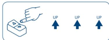
**Attention!** Si la séquence prévoit une répétition de commandes identiques (Up+Up/Down+Down), il est nécessaire d'interposer la position Stop si le type de bouton le prévoit.
