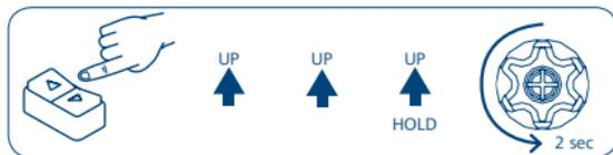
À l'aide du bouton descente de l'interrupteur, porter 2 fois le tablier en position de fermeture complète (verrous en action) pour mémoriser le fin de course bas.
