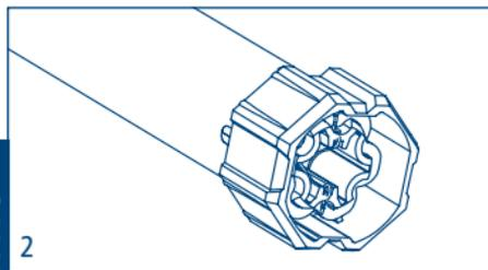
2. Monter la roue sur l'axe de sortie du moteur jusqu'à enclenchement du ressort d'arrêt.
