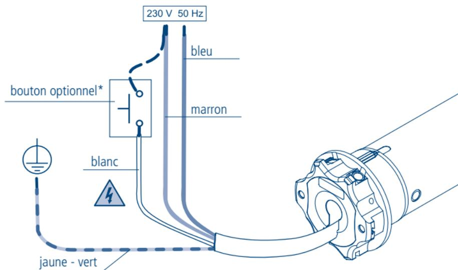
\*L'installation du bouton est facultative; la connexion peut être faite avec la phase (fil marron) ou avec le neutre (fil bleu) indifféremment. Le bouton permet d'actionner le moteur en mode séquentiel (montée, stop, descente, stop, ...).
