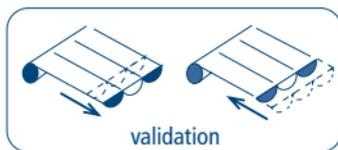
Après réglage et validation de la position de la tension de la toile, le store accomplit une ouverture jusqu'à la position maximale et un retour à la nouvelle position de fonctionnement qui vient d'être confirmée. À partir de ce moment, toutes les commandes à l'ouverture maximale du store s'achèveront par un mouvement dans le sens inverse.
