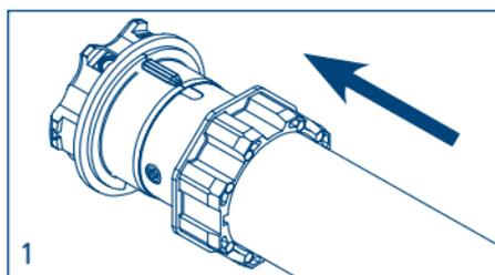
1. Insérer la bague d'adaptation sur la couronne en insérant l'encoche dans le repère rainuré et pousser jusqu'en butée.
